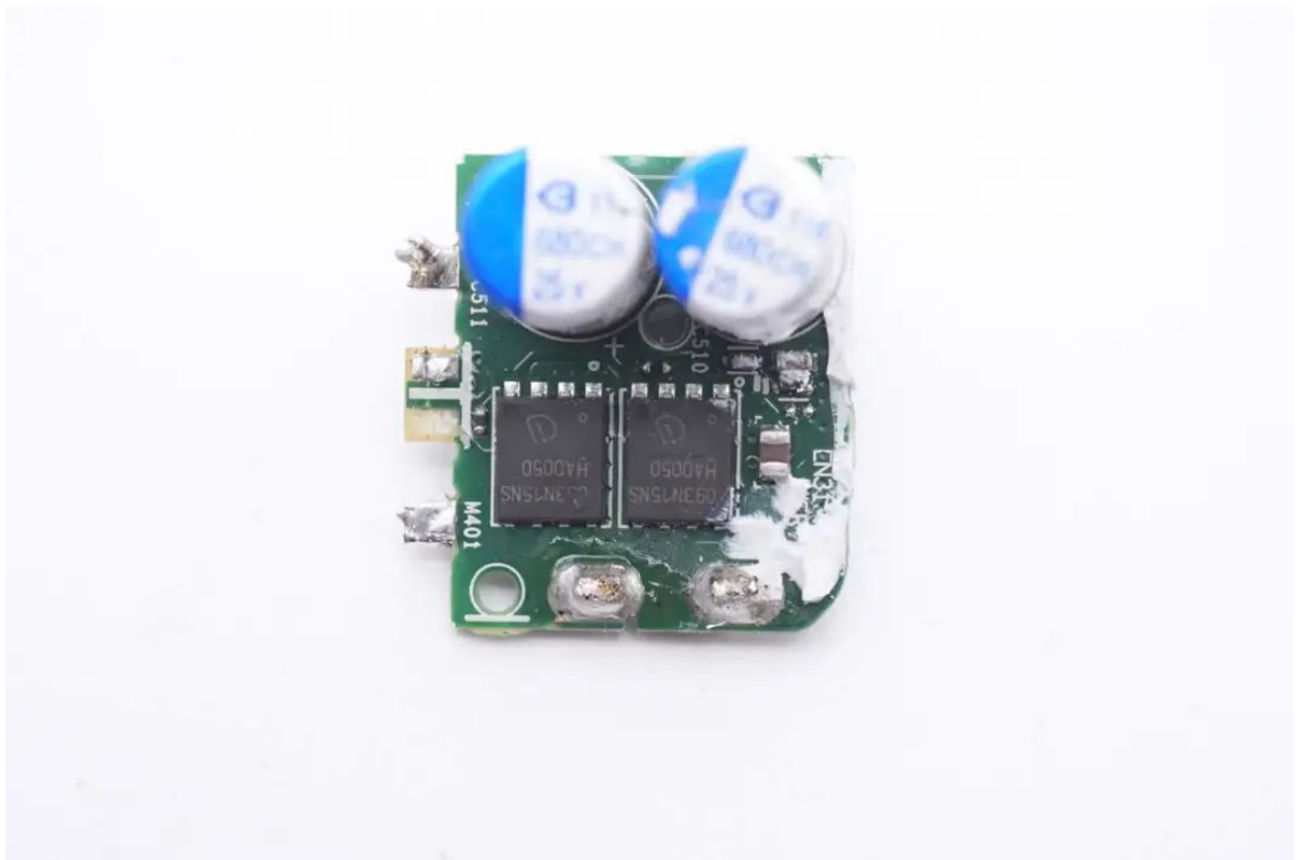
变压器输出焊接到同步整流小板上，小板正面焊接同步整流管和滤波固态电容。
