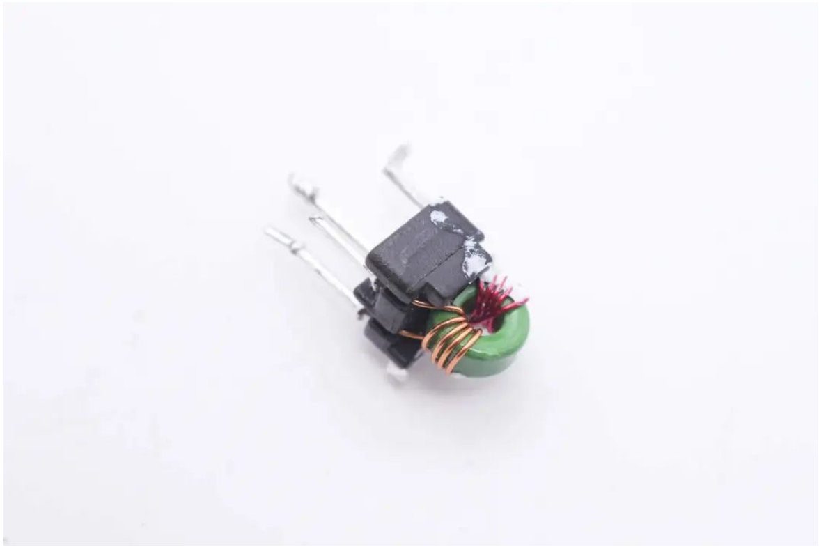
共模电感焊接在保险丝上方。
