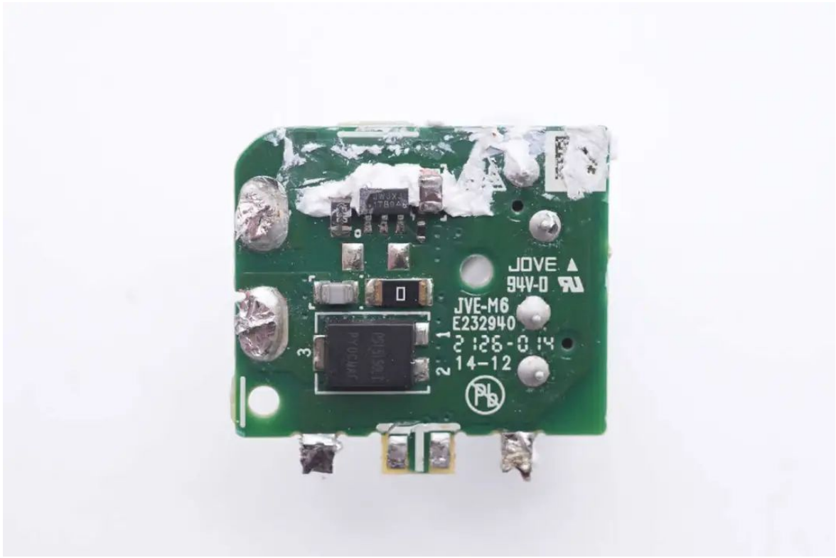
背面焊接同步整流芯片和肖特基二极管。
