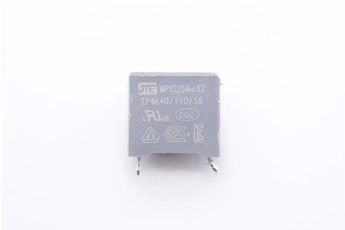
安规X2电容来自STE松田电子，规格为0.22 \mu F。
